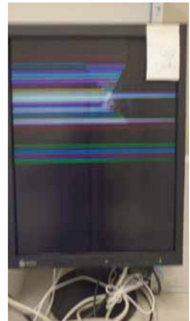
破損した高精細モニタ
