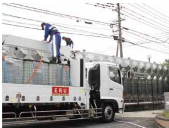
応急的に使用したERUの給水タンクとポンプ
